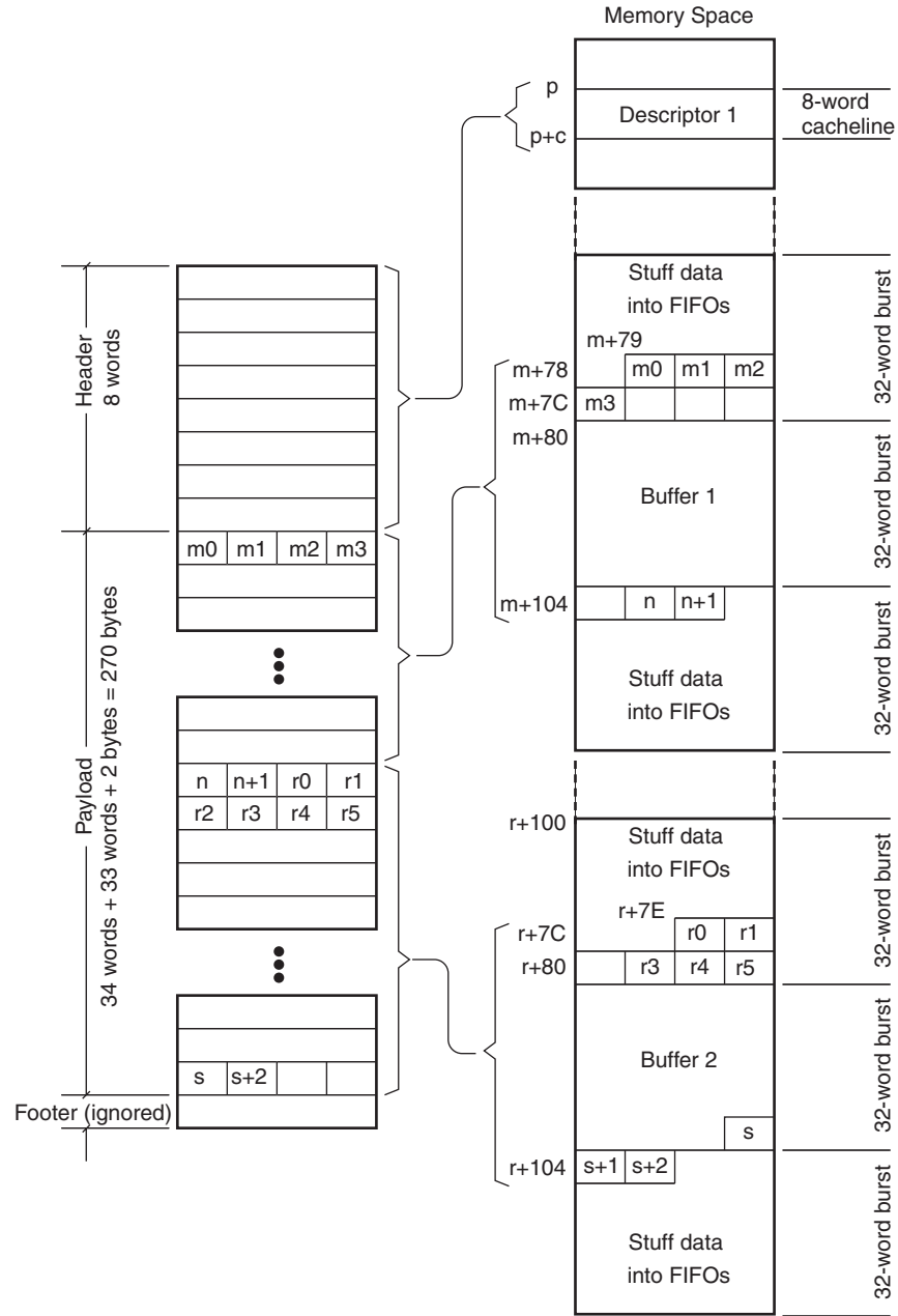
Figure 19: Transmit Byte Shift Example
